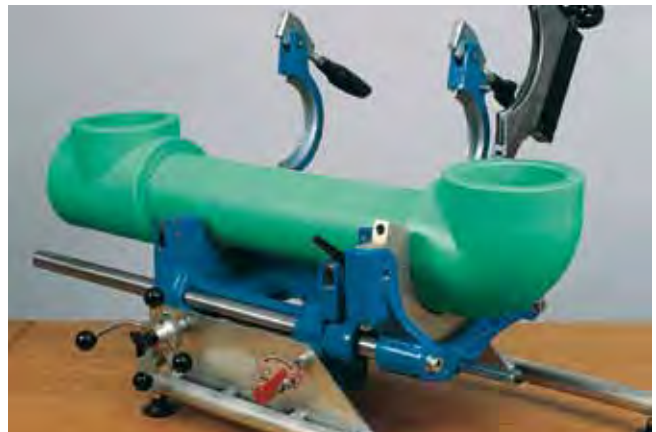
готовое сварное соединение после охлаждения
