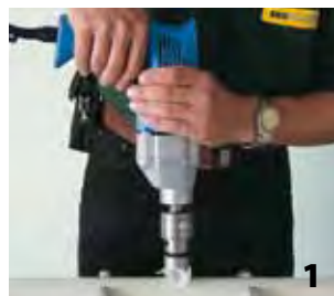
Специальной фрезой высверлить отверстие для седла
